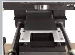
Matrizenbettaufnahme. Werkzeugwechsel auch bei eingespannter Schaltschranktür.
