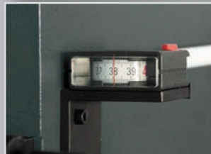
Maßbandanzeige für Y-Achse
