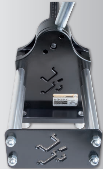
Führungsvorrichtung zum 90°-winkelgenauen Schneiden
